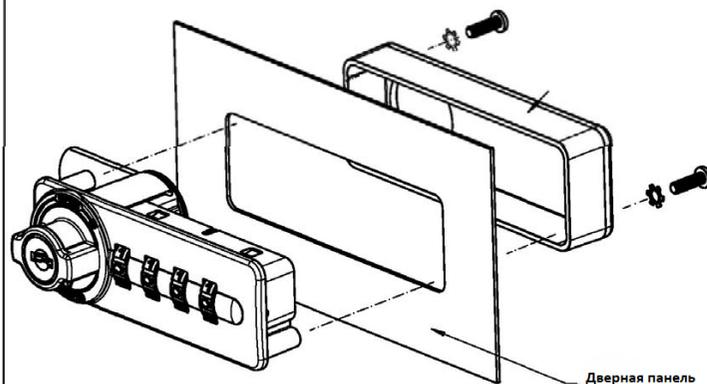
Монтажные отверстия для версии с установкой на поверхности панели
